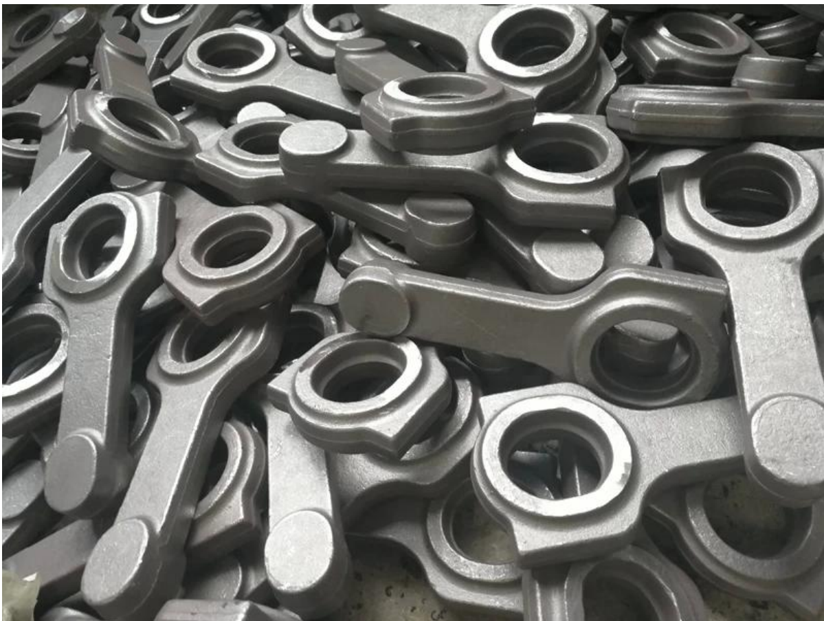
Vorgestelltes Produkt: HOLDEN L67 SUPERCHARGED 3.8L V6 - geschmiedete H-Träger-Pleuel aus 4340 Stahl
