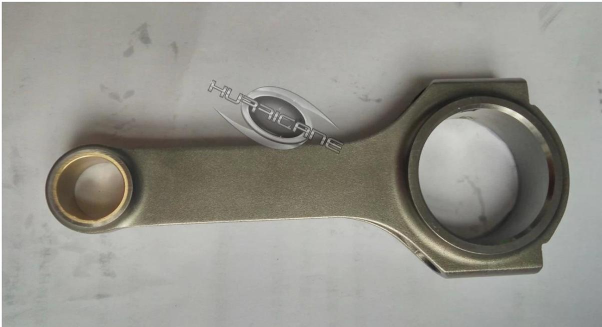
**Hurricane-Leistung Toyota MR2 2.0L Turbo 3SGTE-Pleuel sind direkt für alle 3S-GTE-Motoren geeignet::**
