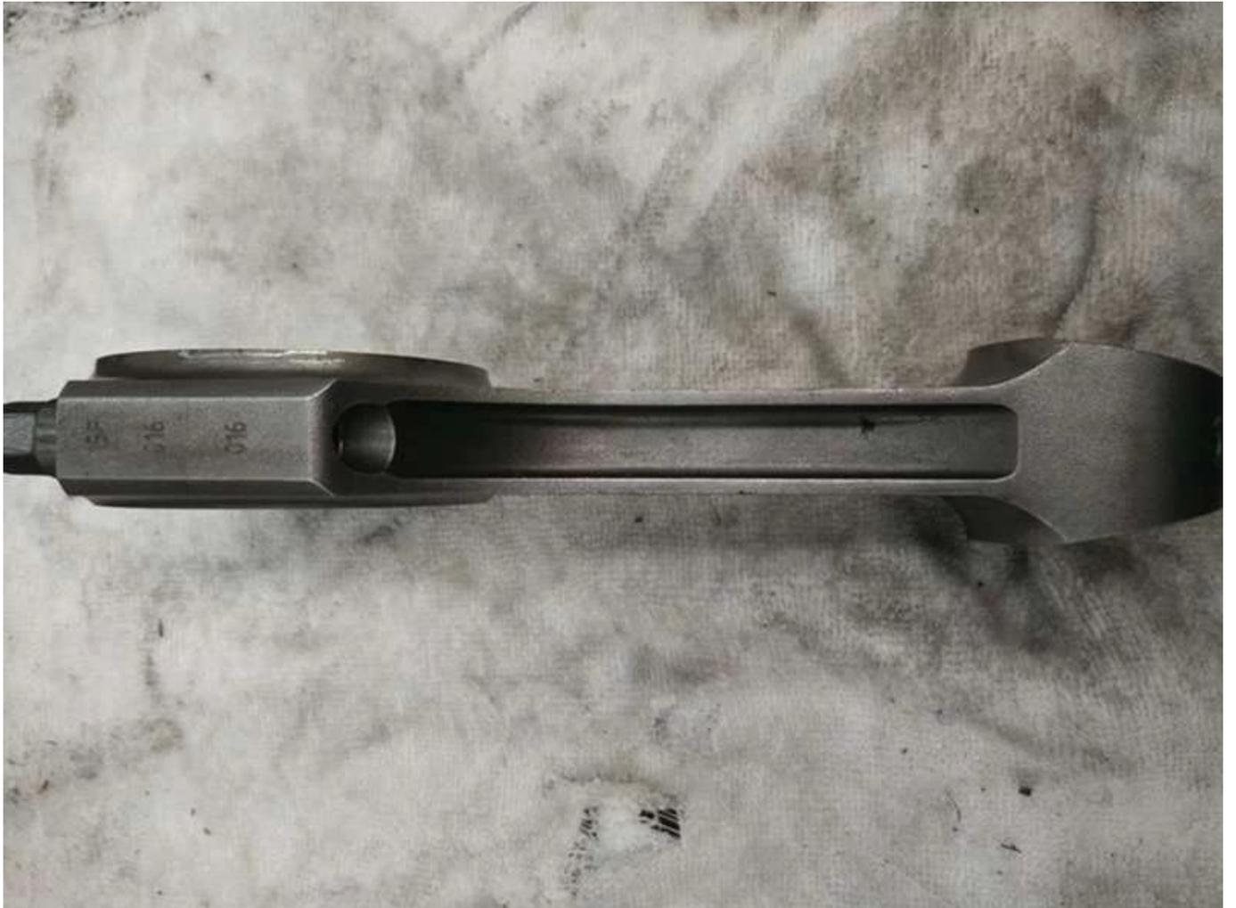
Hurricane fertig 1KD Pleuelstange 1KD Con Rod sind mikopoliert und kugelgestrahlt, um Stree und verbesserte Lebensdauer zu entfernen.
