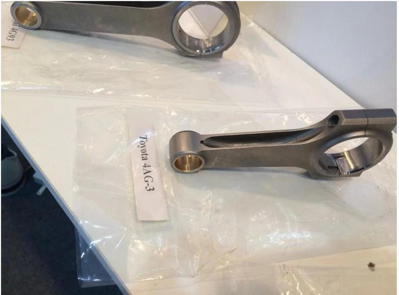
Hurricane Finished H Träger Toyota Corolla 4AGE 16V geschmiedete Pleuelstangen sind perfekt bearbeitet, kugelgestrahlt und geschliffen um die Größe zu nutzen. Abgesehen von H-Beam-Design bietet Hurricane auch I-Beam-Design für 4AGE-Motor. Überprüfen Sie hier, um weitere Details anzuzeigen: [4340 Geschmiedete Pleuelstangen Toyota 4AGZE 122mm Stangen Länge](#). Wenn Sie sich nicht sicher sind, welche Rute Sie für Ihren Build wählen sollten, zögern Sie bitte nicht [kontaktiere uns](#) jetzt
