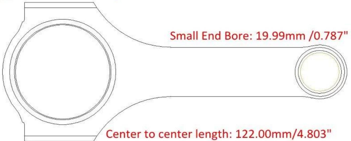
Hurricane Hersteller produziert H Balken Pleuelstangen zum Toyota Celica Corolla MR2 4AG 4AGE AE86 GTS 1.6L Motoren.
