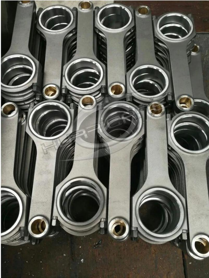
An jeder Stange sind hochwertige Bronze-Kolbenbolzenbuchsen angebracht, um die Verschleißfestigkeit zu erhöhen.
