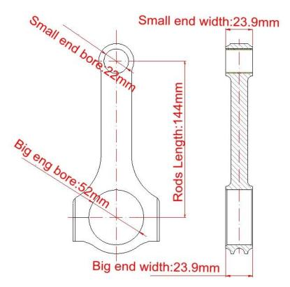
3. BAn jeder Stange sind Ronze-Pin-Buchsen angebracht, um die Verschleißfestigkeit zu erhöhen
