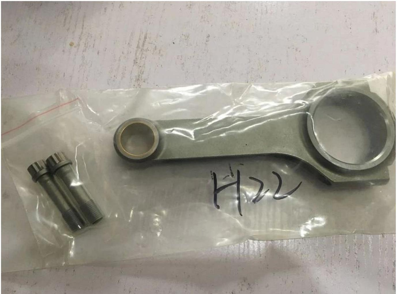
Pro Rute [schuss peened](#) und poliert für ein erhöhtes Ermüdungsleben, so dass die Oberfläche des Rods schöner aussieht. Die Toleranz von H22-Rod-Toleranz wird mit hoher technischer Ebene gesteuert, um den hohen Qualitätsstandard zu erfüllen. Alle HONDA 4340 Performance H22 H-Strahlstangen mit 4 Stück pro Satz verpackt, und ausgewogene Gewichtsstellen innerhalb von +/- 1 Gramm, um das Gleichgewicht gut zu halten.
