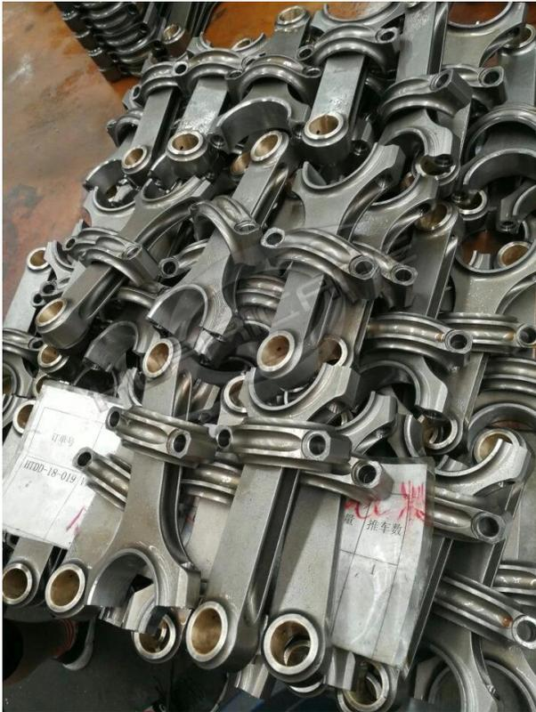
Jede Stange wird von SUNNEN-Geräten mit hoher Toleranz bei [Hurrikanfabrik](#), poliert und kugelgestrahlt, um die Lebensdauer zu verbessern, und mit Bronzebuchsen für Schwimmstifte ausgestattet. T.Schlauchstangen können ca. 1200 PS leisten, daher ist es eine gute Wahl für Ihre Hochleistungsanwendungen bei gleicher Preisklasse. Wichtigersind sie verfügbar mit [ARP 8740, ARP 2000 und ARP L19](#) Stangenschrauben für Chrysler-Anwendungen mit höherer Festigkeit.
