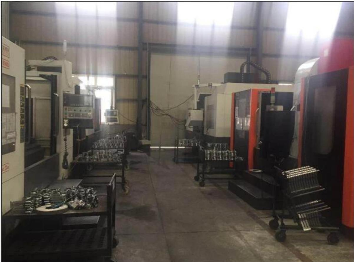
Diese Mühlen, Schleifen und Bohren auf dem verbindenden Stab. Die meisten Fabriken benutzen für die Maschine mit Arbeiter, die eine zeitaufwändige Prozess war. Um die Zeit zu verkürzen und die Qualität der Stäbe zu verbessern, sind gegenwärtig alle Stäbe mit kompletter CNC Maschine bearbeitet.
