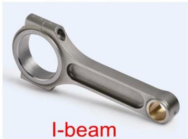
Hurricane gemacht Pleuelstangen perfekt passt Honda J35 Motoren, Schrauben Größe: ARP2000 3/8 unter Kopf Länge 1.600 ". Unsere Abmessungen Präzisionsanforderung ist hoch. Keine Note Toleranz: +/- 0,15. Shot Penning die Oberfläche der Stange kann Stress während entlasten Hurricane fertigte verschiedene Arten von Pleuelstangen für verschiedene Honda Motoranwendungen. [Klick hier](#) für mehr Modell.
