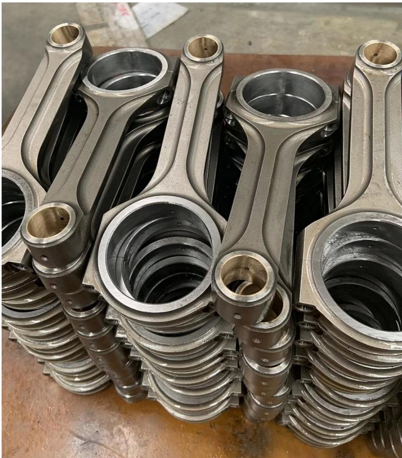
Die geschmiedeten 4340 Stahl-Pleuelstangen für 4G63T-Motoren können gereinigt, geprüft und verpackt werden.
