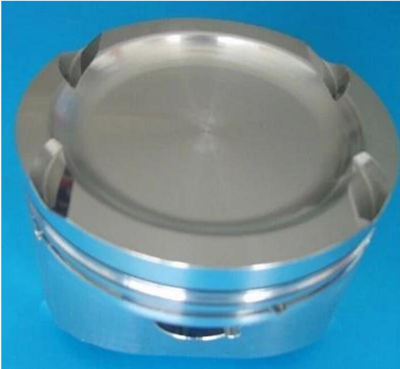
Hinweis: Normalerweise werden Tellerkolben in verstärkten Anwendungen eingesetzt, bei denen keine Nockenwelle mit hohem Hub und keine hohe Verdichtung erforderlich sind.
