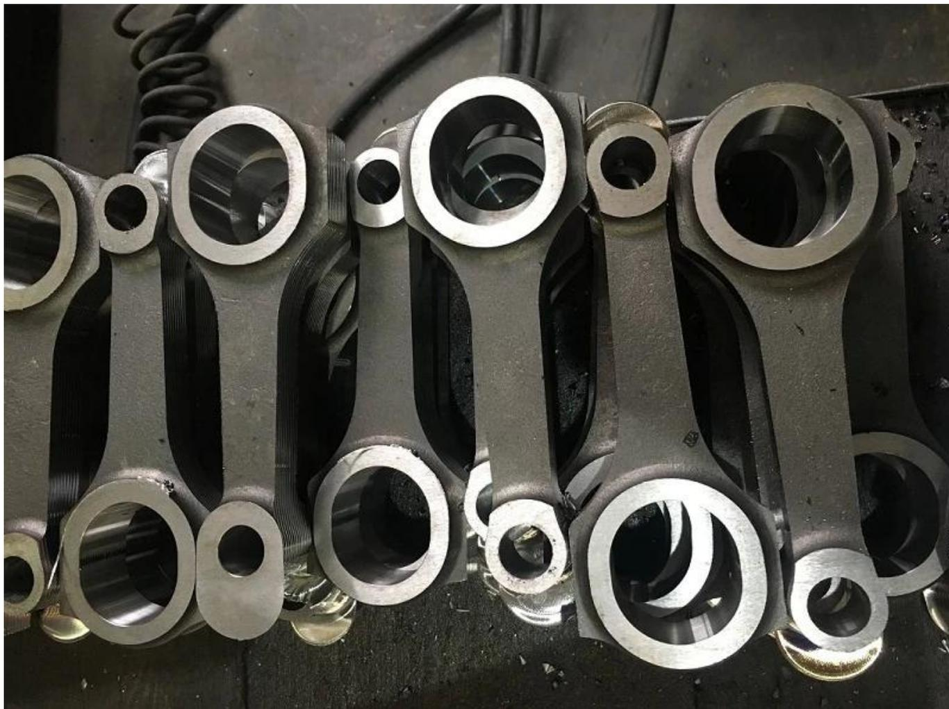
Dies ist ein Fortschritt der großen und kleinen Endbohrung, die bei jedem Prozess als zuverlässiger Ortungspunkt dient. Hurricane BMW M60 143 mm geschmiedete Pleuelstangen wurden für Anwendungen entwickelt, bei denen die Stärke der Stange die Nummer eins ist, die über 1.000 PS pro Satz bewertet wird. Sie sind für BMW E38, E39 - 4.0 4.4 V8-Motoren geeignet.
