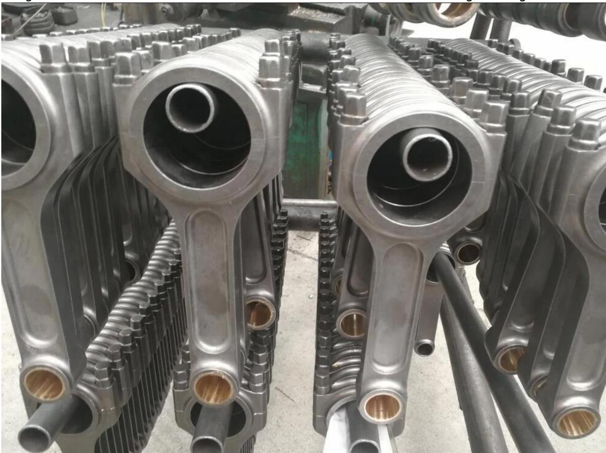
Sie könnten standardmäßig mit ARP 8740 und ARP 2000-Stabschrauben mit 190.000 psi und ARP L-19 mit 265.000 psi als Upgrades geliefert werden. Anweisungen und Stabschmierung sind enthalten.
