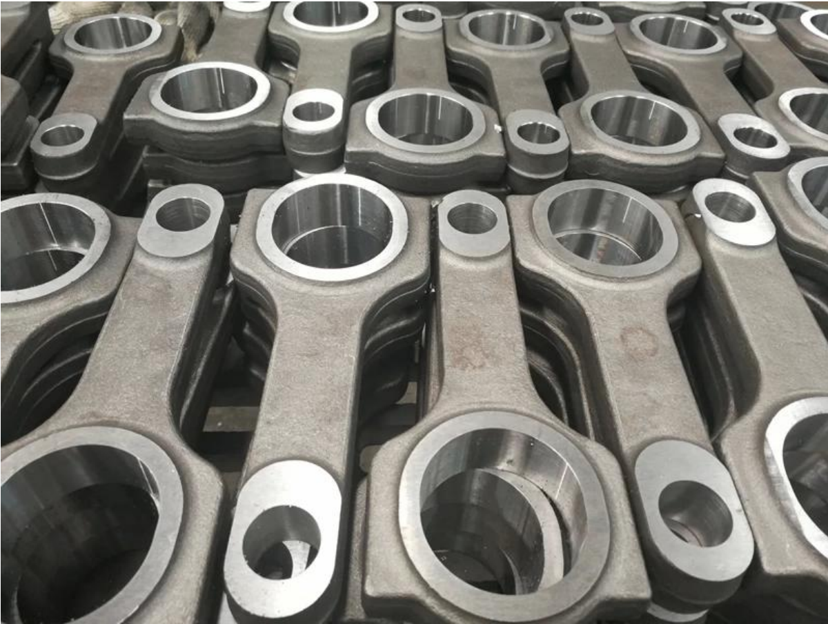
Hinweis: Große Endbohrung und kleine Endbohrung bohren
