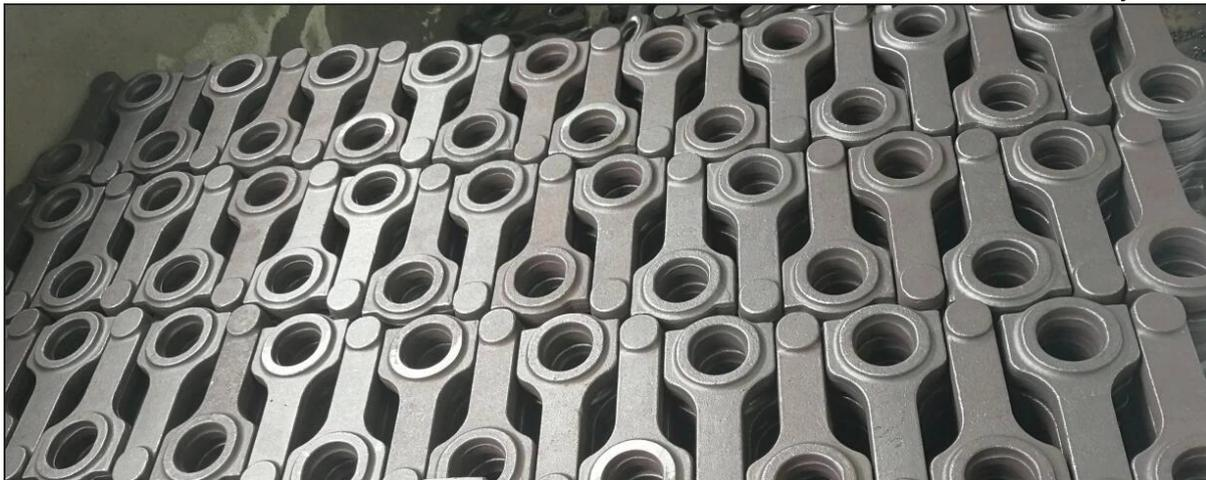
Dann bearbeitete ich sie auf einer CNC-Maschine, schleudern, schleifen und bohren
