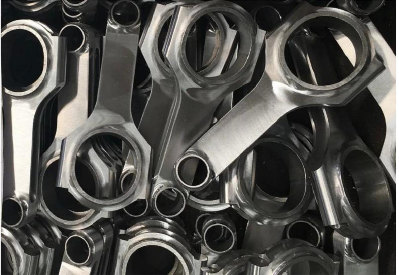
Hinweis: Grating, Polieren, (entfernen Grate und machen Oberfläche glatt) und Schuss Strahlen (kleine Kugel Hit Oberfläche und machen Sie auf der Oberfläche, erhöhen Stäbe Stärke mit kleinen Ball) sind alle entscheidenden Operationen in der Herstellung eines Wettbewerbs Pleuelstange. Genauere Informationen finden Sie unter: [Hurricane Hochleistungs Pleuel-Prozess der Bearbeitung von Stäben](#) Oder überprüfen Sie unsere operations auf YouTube Viedo: [Wie es gemacht wird: Pleuelstange](#)
