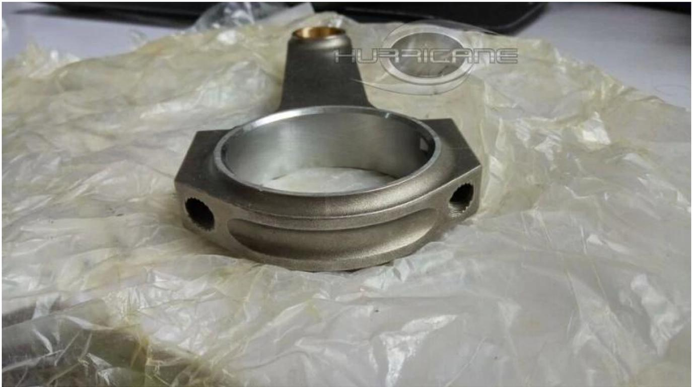
Hurricane luftgekühlte Leistung Pleuelstangen können mit Kopie Arp2000 3/8 Stab Schrauben, PSI 211.829, Gewicht: 38g pro Stück ausgestattet werden. wenn installieren Kopieren ARP2000 3/8 stange schrauben, unsere schrauben drehmoment ist 75N \* M, als Korrekten stange schrauben drehmoment ist lebenswichtig für pendelstange lebensdauer. Hurricane geschmiedete luftgekühlte Pleuelstangen können auch perfekt mit originalen "ARP" Pleuelstangenbolzen kombiniert werden.
