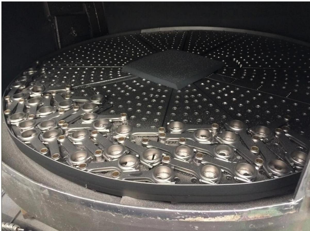
Hinweis: Dies ist die Strahlmaschine.
