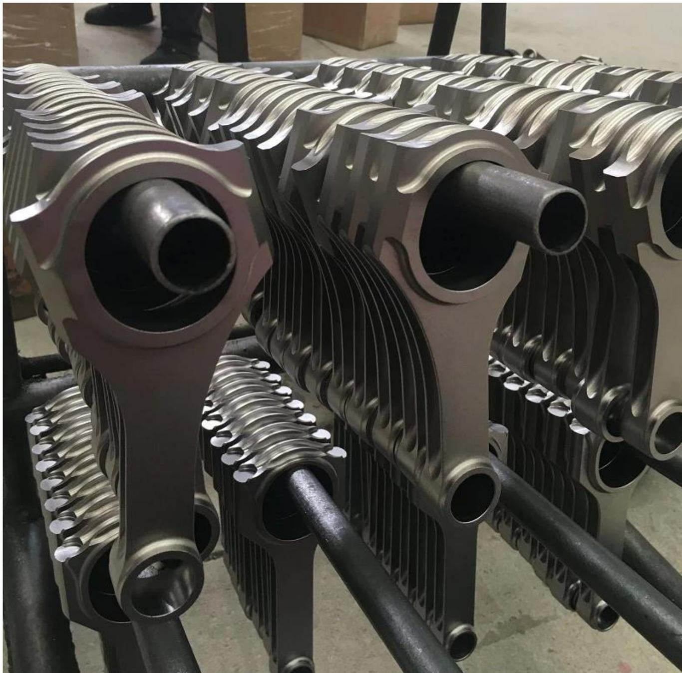
Hurricane Speed And Performance ist ein Hersteller von Hochleistungs-Pleuelstangen mit Sitz in Chengdu, China. Ausgestattet mit vollständiger CNC-Ausrüstung und professionellem Personal. Dies ist ein Teil unserer neuen H-förmigen Toyota FRS / FA20-Pleuelstangen. Bitte wenden Sie sich an [kontaktiere uns](#) Muster anfragen oder eigene Performance-Pleuel fertigen.
