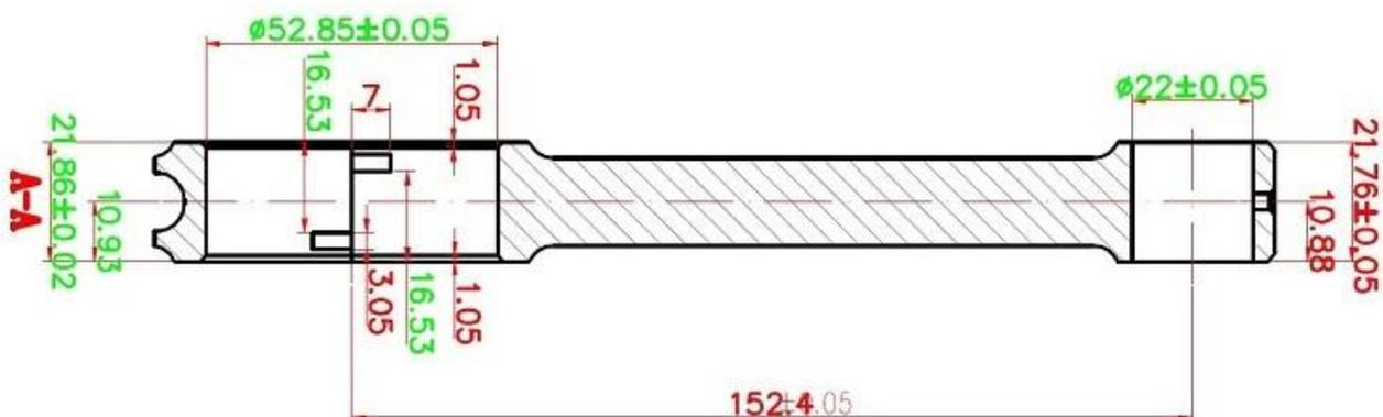
Nissan Performance 6.000 "152.4mm Pleuelstangen sind direkt passend für alle Nissan / Holden RB30 Motoren. Es gibt keine Bearbeitung irgendwelcher Art. Sie passen RB30ET (SOHC), RB30DET (DOHC) und RB30 Motoren. Jede Stange ist bronze gebushed für volle Schwimmfähigkeit Die Ölbohrungen am Stiftende stellen eine zusätzliche Schmierung und Kühlung dar. Das H-Profil kann höhere Druckbelastungen
