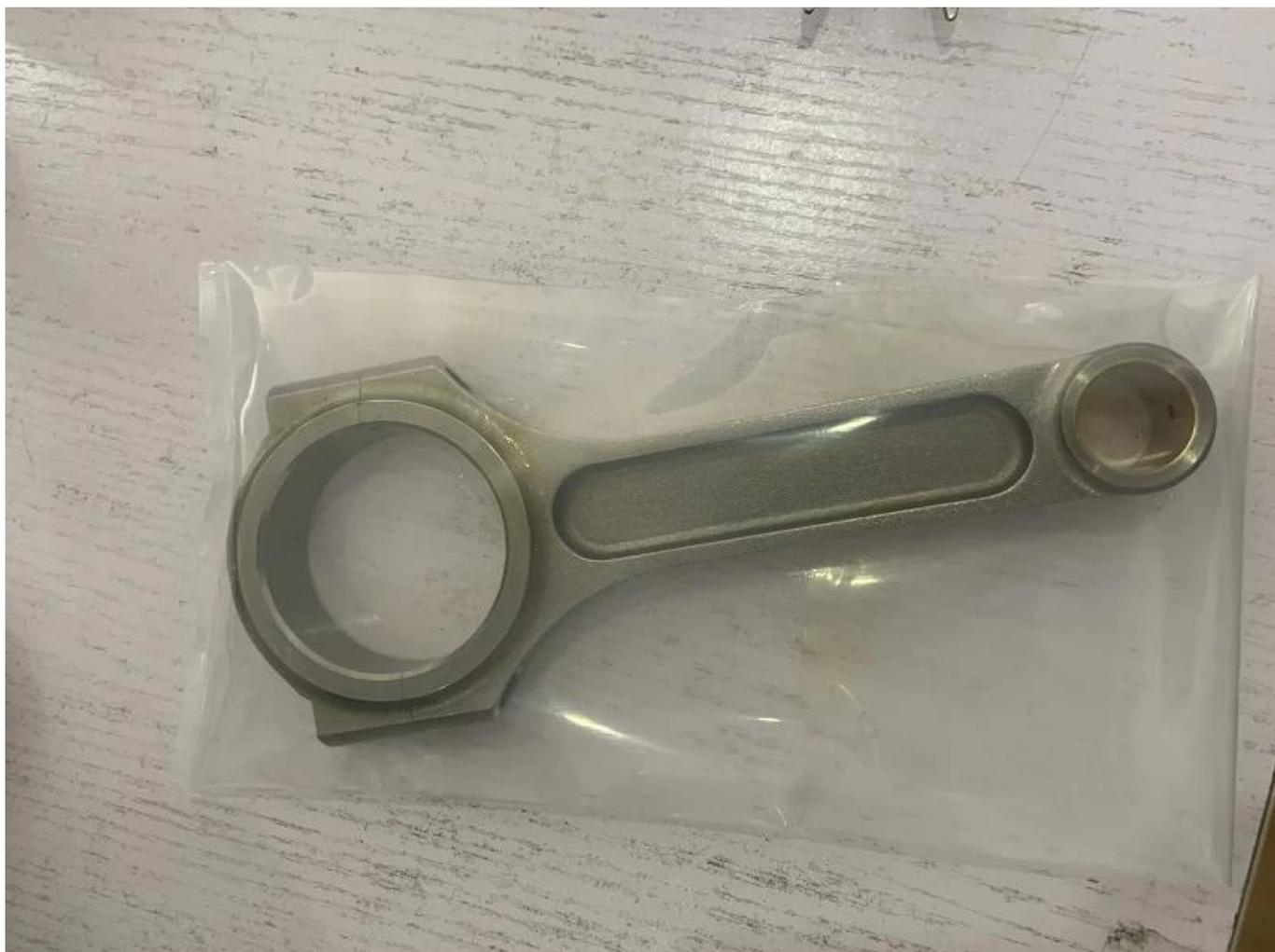
Les bielles I Beam sont la bielle à ajustement direct de haute résistance ultime pour tous les moteurs Nissan RB30. Ces bielles sont conçues pour supporter la punition la plus extrême des moteurs RB les plus énervants.
